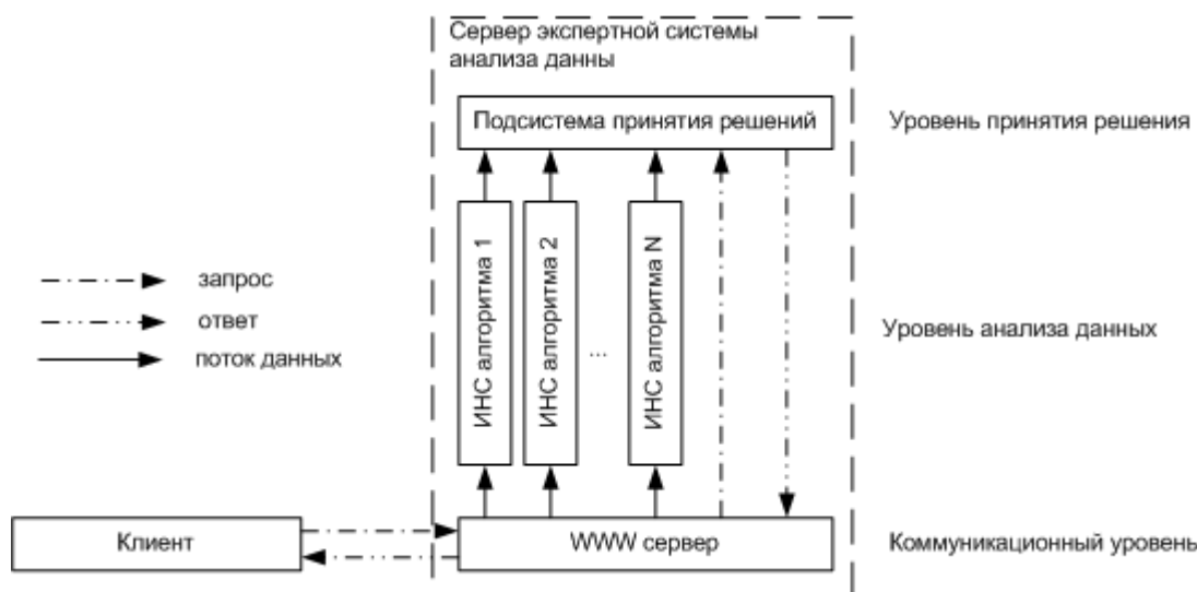
Рис. 2.1. Структурно-функциональная схема экспертной системы выбора оптимального алгоритма планирования действий
