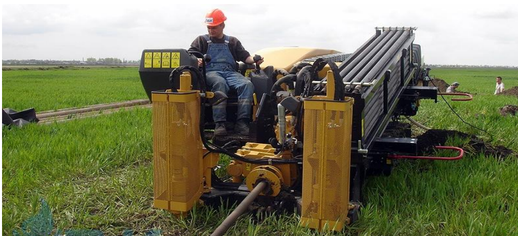
Рис. 5.9. Машина горизонтально-направленного бурения в работе
