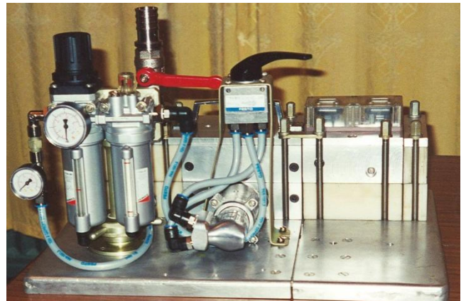
Рис. 5.5. Инжектор ПСИ-1 для задувки кабеля
