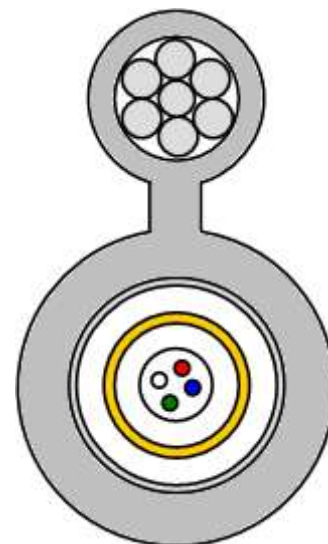
Рис. 2.5. Поддерживающий силовой элемент («восьмерка»)
