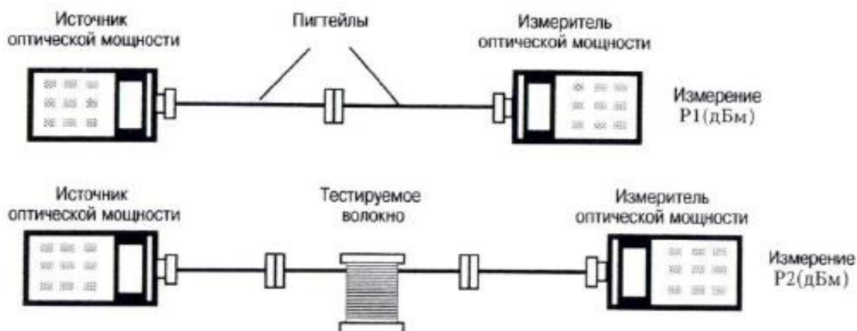
Рис. 10 Метод светопропускания: способ вносимых потерь
