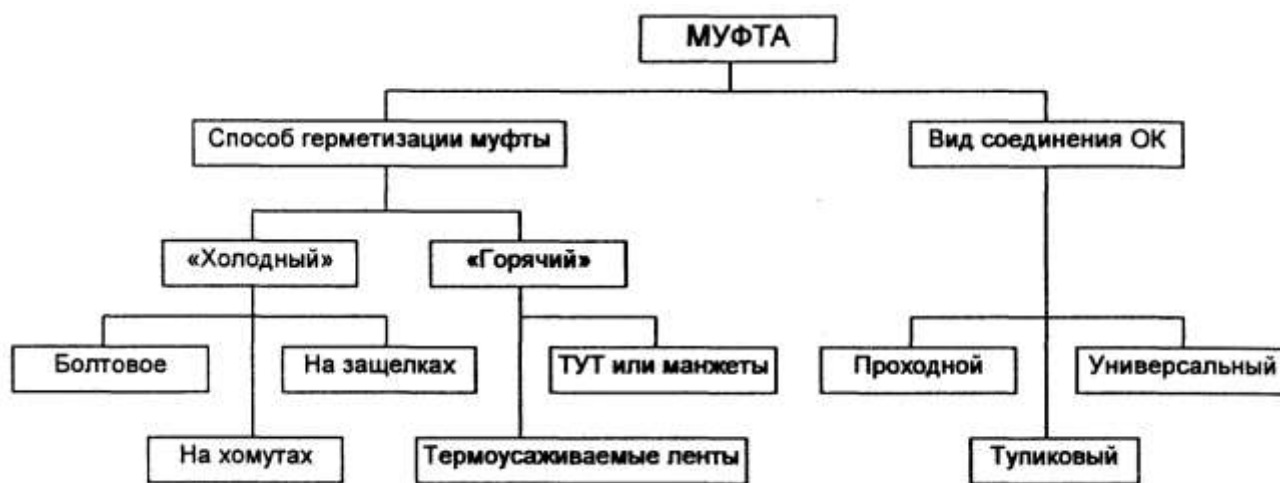
Рис. 14.2 Классификация конструкции по способу герметизации и виду соединения
