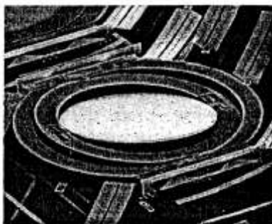
Рис. 15.6. Вариант карданной подвески круглого микрозеркала
