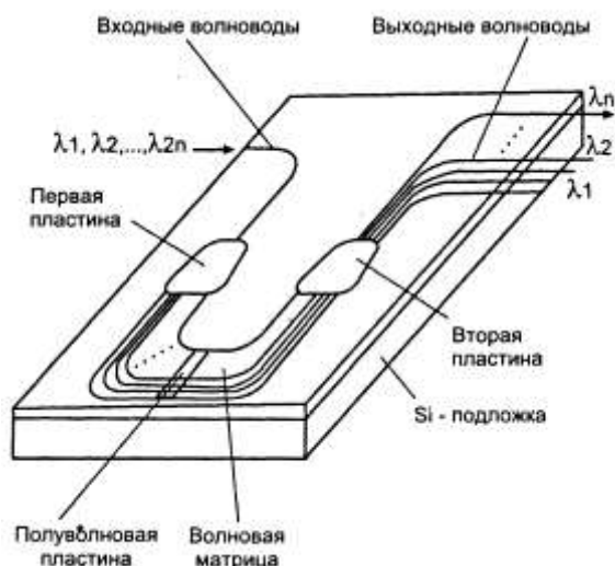
Рис. 16.2. Схема устройства волноводного мультиплексора
