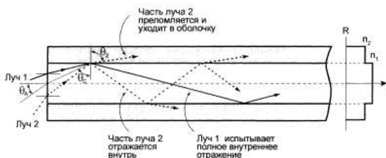
Рис. 10.1. Ход лучей в многомодовом оптическом волокне со ступенчатым профилем
