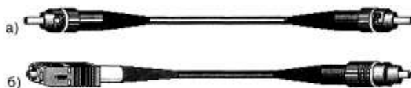
Рис. 12.9. Примеры одиночных оптических шнуров: а) ST-ST; б) SC-ST
