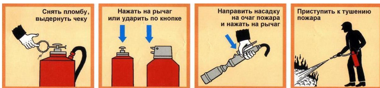
Рис. 7.11. Приведение в действие воздушно-пенного огнетушителя
