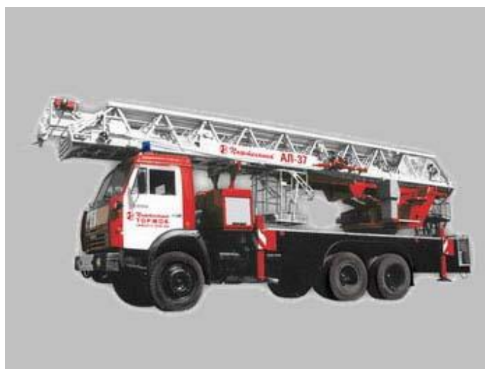
Рис. 6.8. Внешний вид пожарной автолестницы АЦ-37 (подъем люльки на 37 м)
