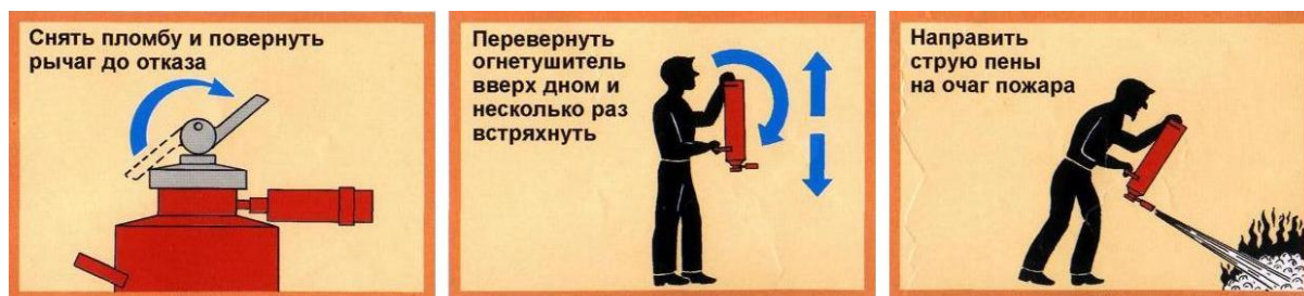
Рис. 7.9. Приведение в действие химического пенного огнетушителя
