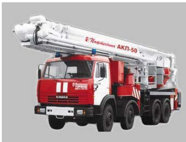
Рис. 6.9. Внешний вид пожарного коленчатого автоподъемника АКП-50 (подъем люльки на 50 м)
