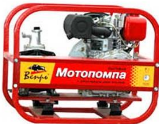
Рис. 6.17. Мотопомпа Вепрь МП-120-ДЯ (производительность 120 л/мин, напор 70 м, глубина всасывания 8 м)
