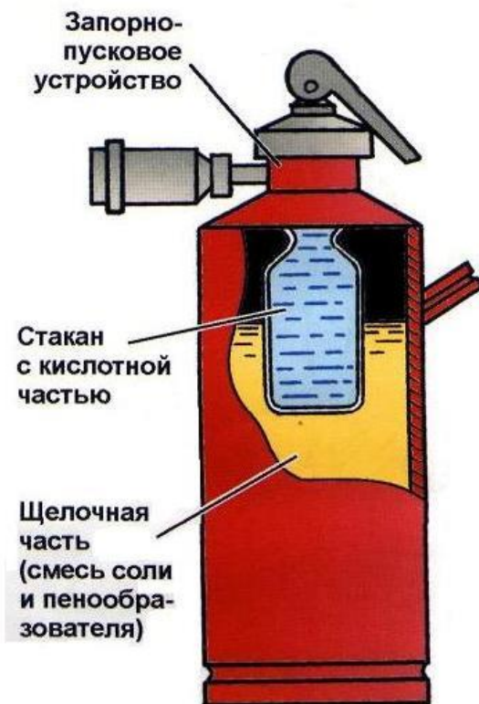
Рис. 7.8. Внутреннее строение химических пенных огнетушителей
