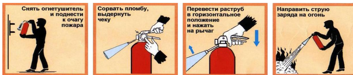
Рис. 7.4. Приведение в действие ручного углекислотного огнетушителя
