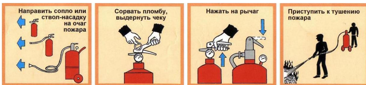
Рис. 7.17. Приведение в действие закачного огнетушителя
