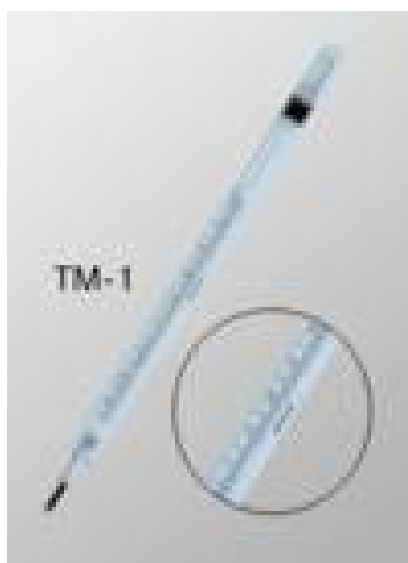
Термометр ртутный метеорологический максимальный ТМ-1
