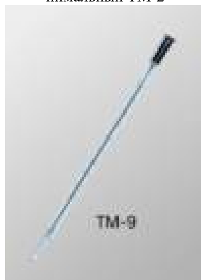
Термометр спиртовой метеорологический низкоградусный ТМ-9
