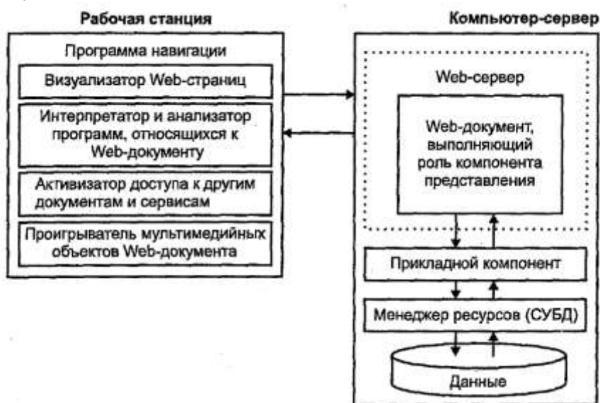
Рис.1.6. Архитектура «клиент-сервер», основанная на Web-технологии
