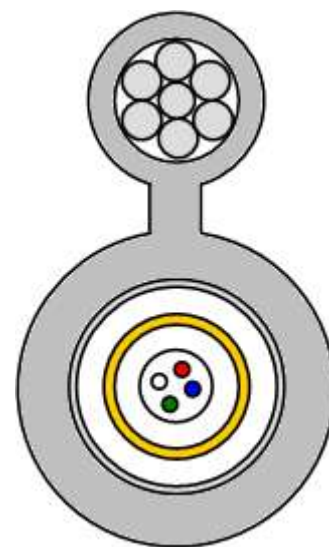
Рис. 1.5. Поддерживающий силовой элемент («восьмерка»)
