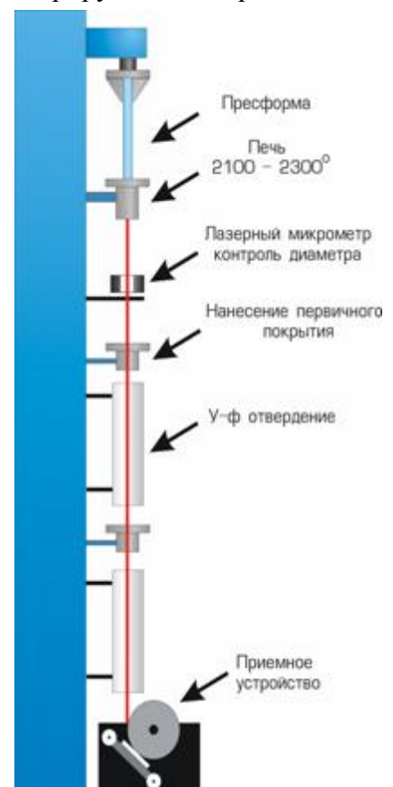
Рис. 3.6. Вытягивание ОВ из заготовки
