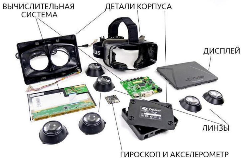
Рис.114 Устройство VR шлема
