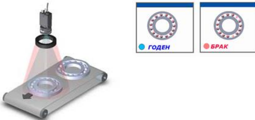
Рис.73 Контроль сборки деталей на конвейере с помощью видеокамеры.
