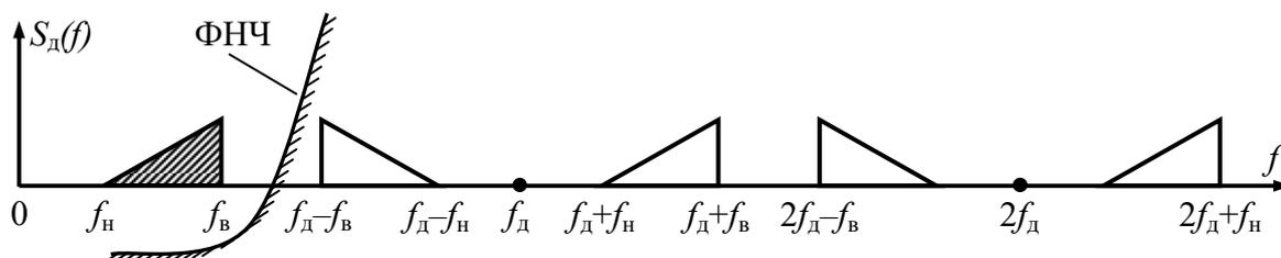
Рис. 1. Спектр дискретного сигнала
