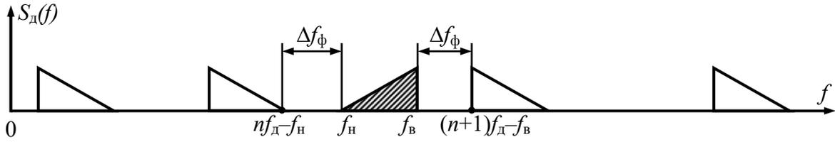
Рис. 3. Спектр дискретного сигнала
