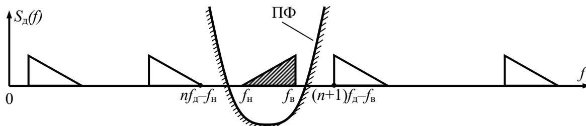
Рис. 2 Спектр дискретного сигнала
