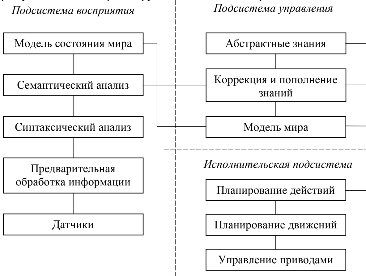
Рис. 1. Структура информационной системы интеллектуального робота
