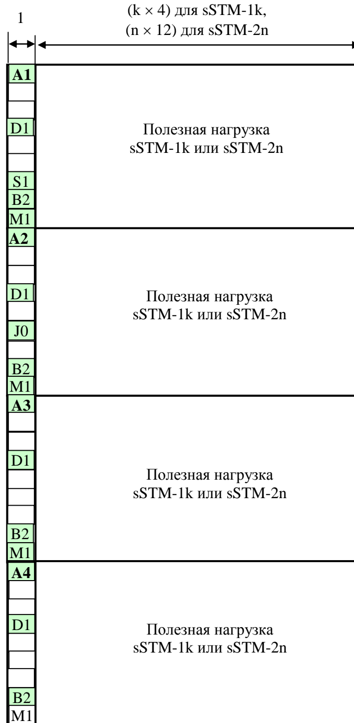
Рис. 2. 9. Структура сигналов sSTM-1k, sSTM-2n на интервале времени 500 мкс
