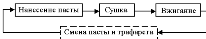
Рис. 4.41. Структурная схема технологического цикла толсто пленочной печати
