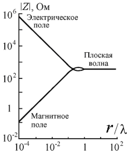
Рис. 3.30. Волновые сопротивления электрического и магнитного полей
