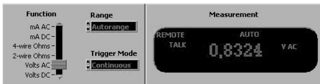
Рис. 1.5 – Лицевая панель ВП DMM
