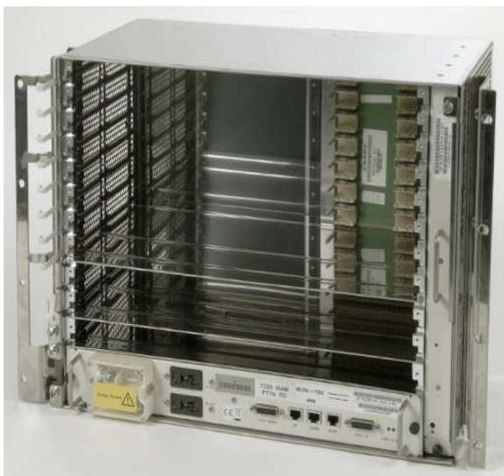
Рис. П.3.3: Внешний вид полки ISAM 7330 FD без плат
