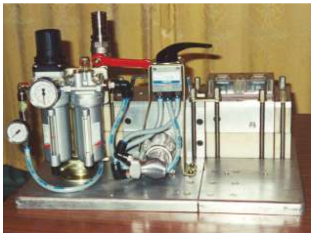
Рис.9.5. Инжектор ПСИ-1 для задувки кабеля.
