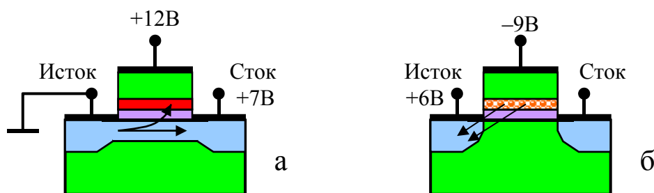
Рис. 6.5. Размещение (а) заряда на плавающем затворе транзистора и его удаление (б)
