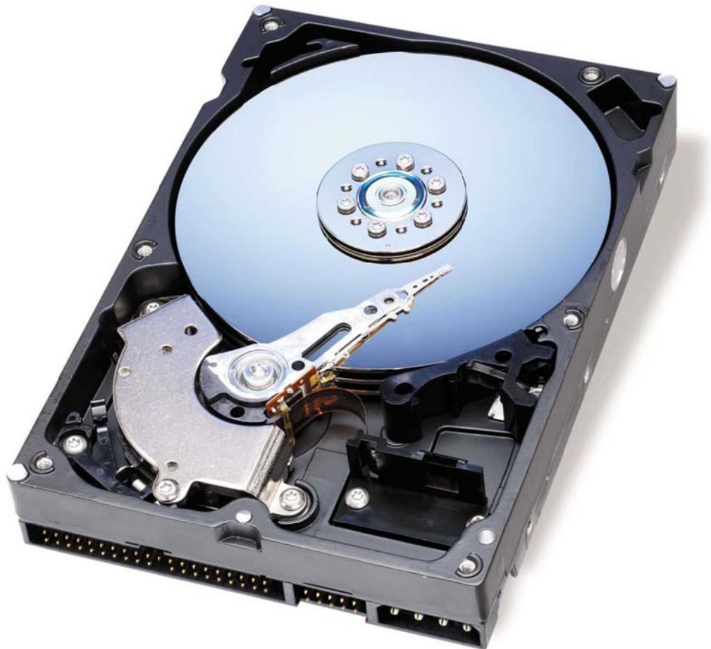
Рис. 5.1. Компьютерный HDD-накопитель со снятой крышкой
