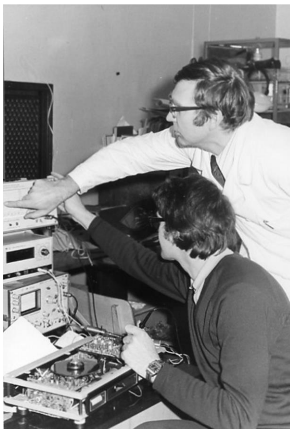
Рис. 1.4. Научные сотрудники В. Коченов и Л.Штутман занимаются настройкой сервосистем лазерного проигрывателя «Луч-001»
