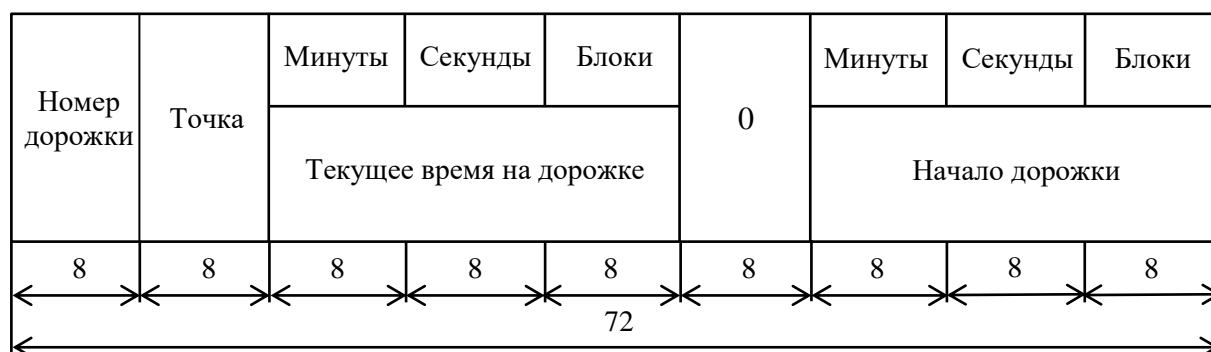
Рис. 5.21. Структура данных первого варианта режима 1 (вводная дорожка)
