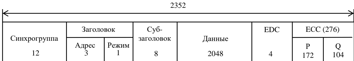
Рис. 6.8. Структура сектора данных диска CD-ROM/XA в форме 1
