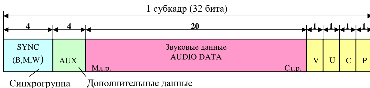
Рис. 13.1. Формат субкадра интерфейса AES3
