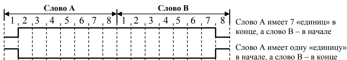
Рис.2.3. Две наихудшие ситуации, которые могут возникнуть при соединении двух слов в коде NRZ-E
