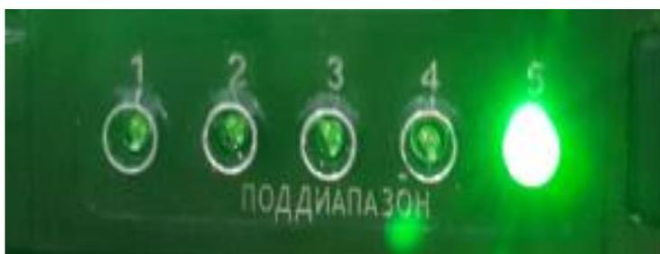
Рис. 6.6 Пятому каналу на дисплее соответствует светодиод-индикатор 5
