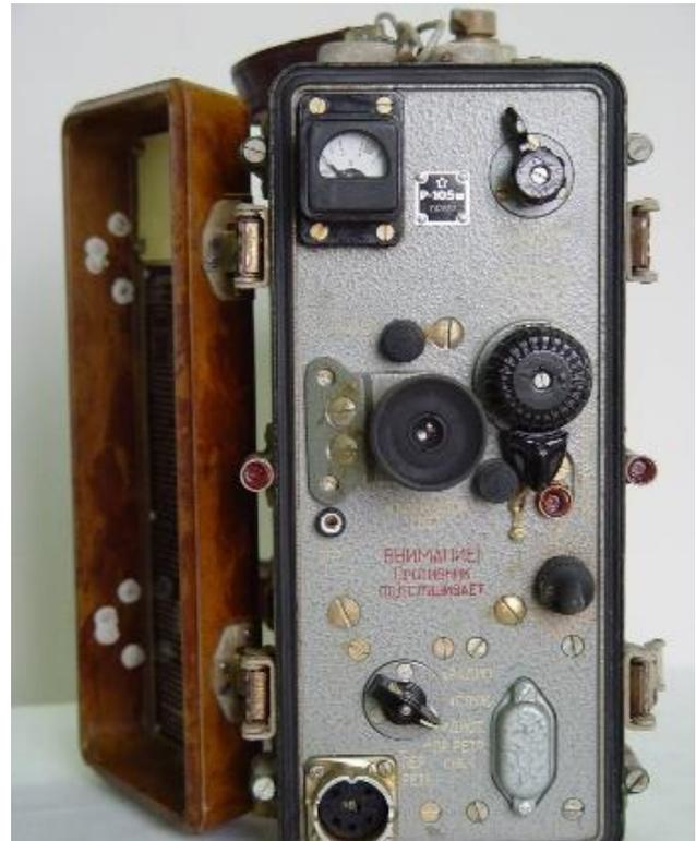
Рис. 3.1. Радиостанция Р-105М
