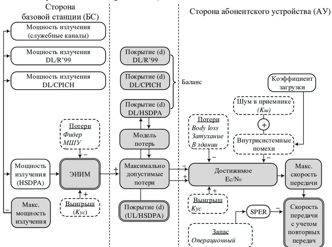
Рис.8.15. Алгоритм расчета пропускной способности в каналах HSDPA
