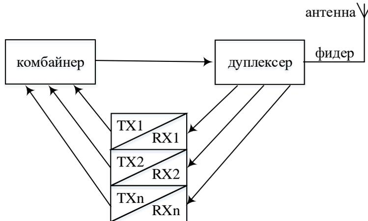
Рис. 3.2. Структурная схема базовой станции GSM
