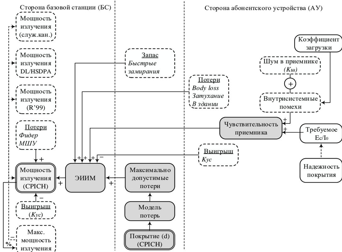
Рис.8.14. Алгоритм расчета требуемой мощности в канале CPICH
