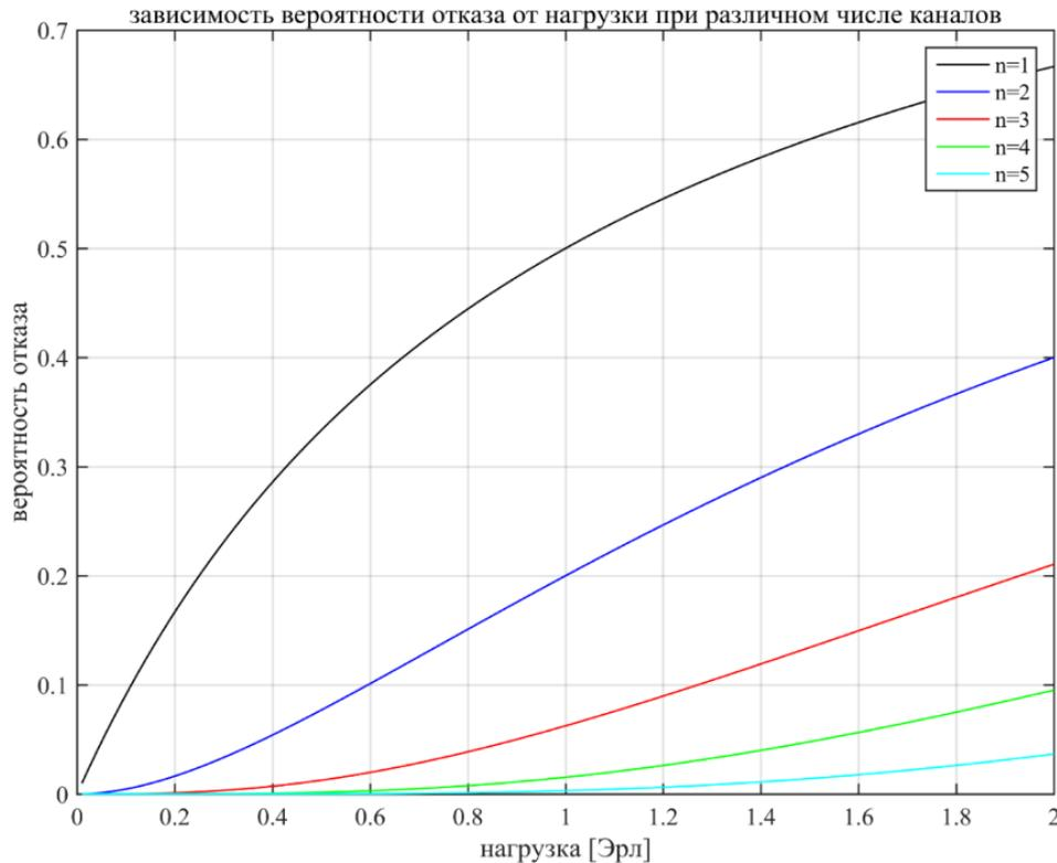
Рис. 1.2. Зависимость вероятности отказа от нагрузки при различном числе каналов
