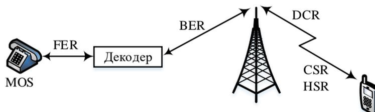
Рис.6.8. Точки измерения параметров качества функционирования сети GPRS/UMTS при соединении типа «мобильный телефон – фиксированный телефон»
