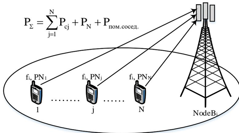
Рис.7.1. Разделение сигналов от абонентских терминалов в линии «вверх» сети UMTS
