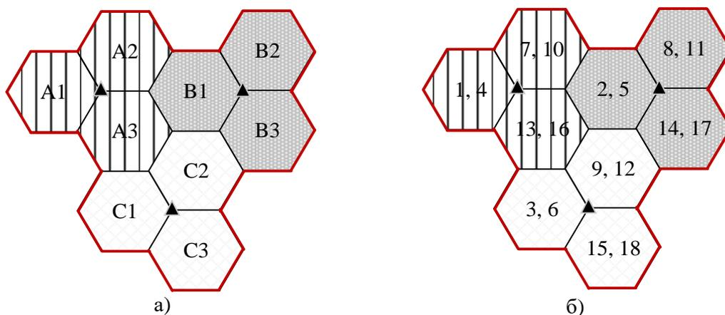
Рис. 5.2. а) Кластер  $3/9$ ; б) Пример распределения 18 частот для кластера  $3/9$
