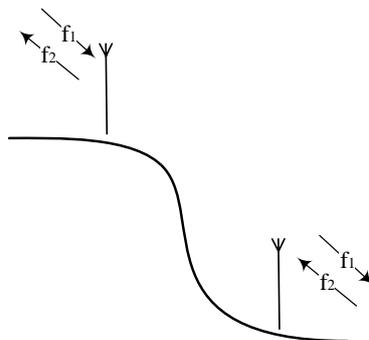
Рис. 6.3. Одночастотный ретранслятор
