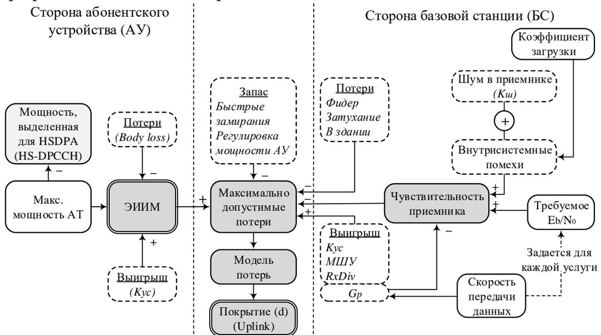
Рис.8.11. Алгоритм расчета зоны покрытия по восходящему каналу UL
