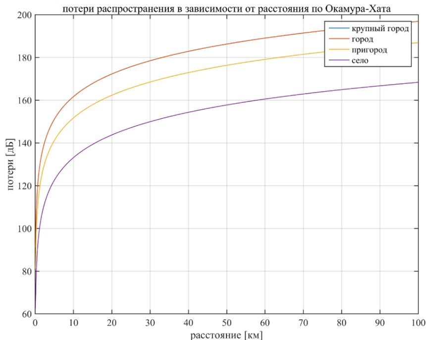
Рис. 1.4. Зависимость потерь распространения от расстояния по модели Окамура-Хата
