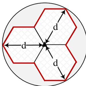
Рис.8.10. Площадь покрытия традиционной трехсекторной соты гексагональной формы
