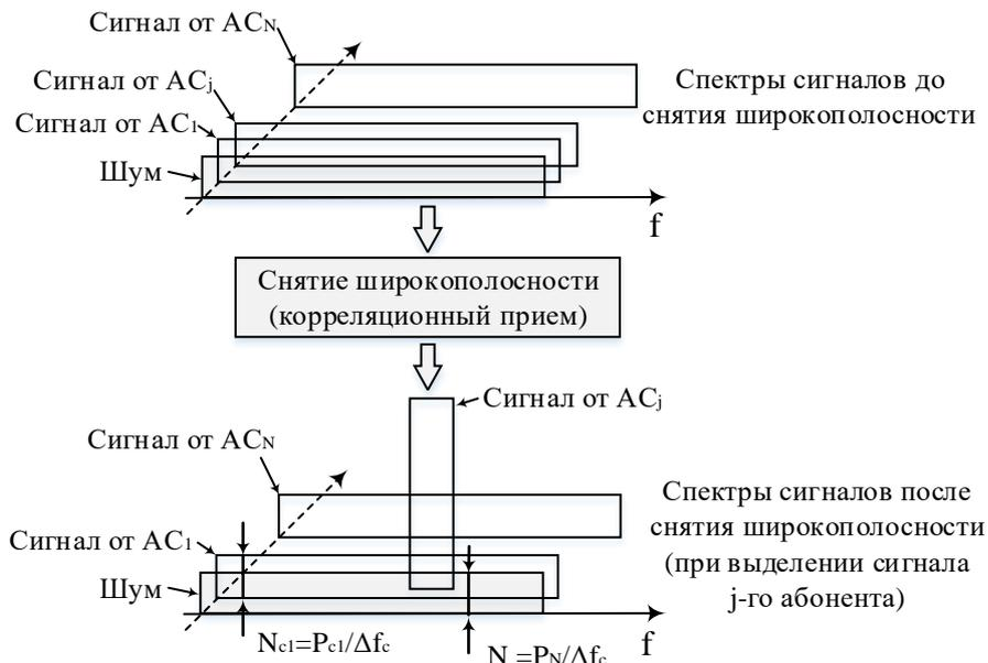
Рис.7.2. Выделение полезного сигнала  $j$ -й АС в приемнике линии «вверх» сети UMTS
