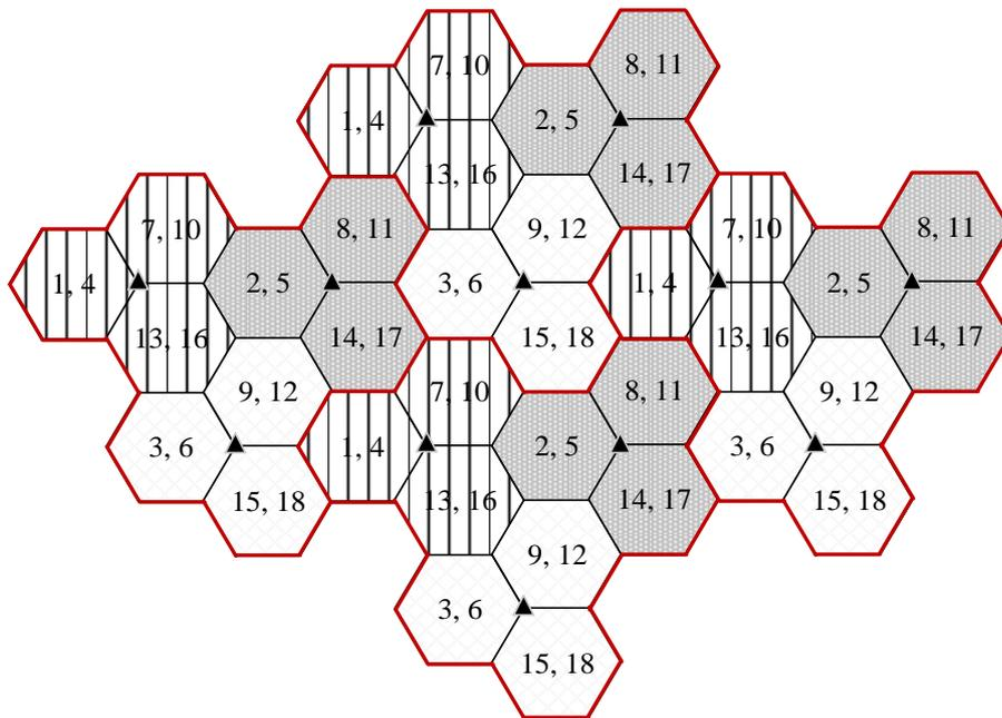
Рис. 5.3. Пример распределения 18 частот для фрагмента радиосети из 4-х кластеров  $3/9$
