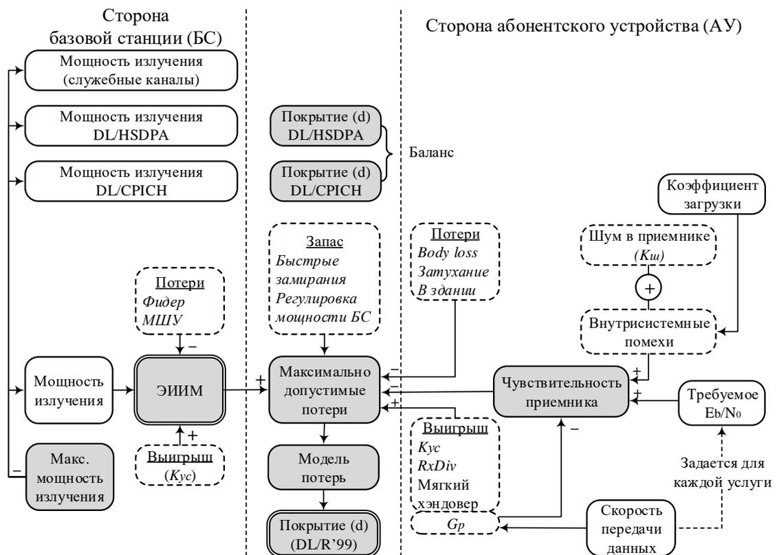
Рис.8.12. Алгоритм расчета зоны покрытия по нисходящим каналам DL (R'99)
