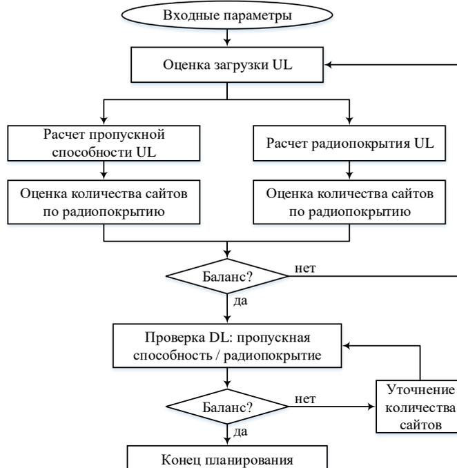
Рис.8.6. Балансировка асимметрии DL/UL
