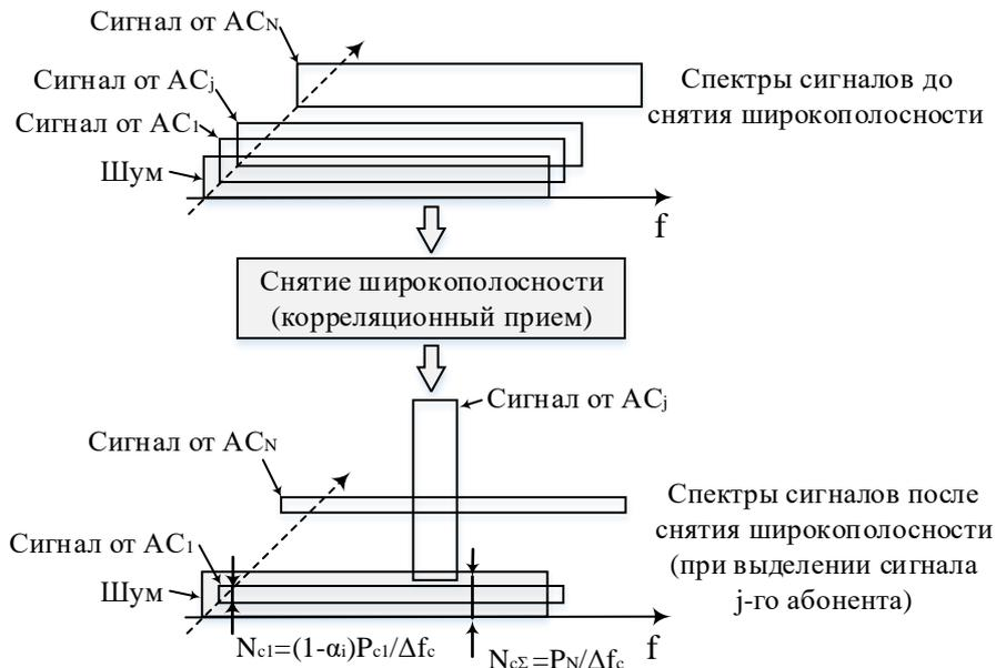
Рис.7.4. Выделение полезного сигнала  $j$ -й АС в линии «вниз» сети UMTS
