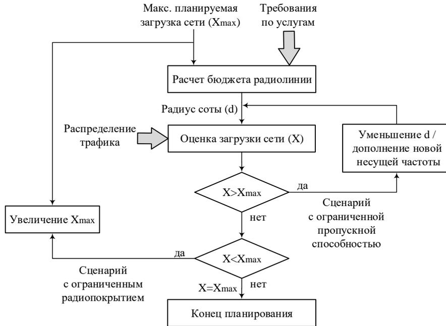
Рис.8.5. Балансировка пропускной способности и радиопокрытия
