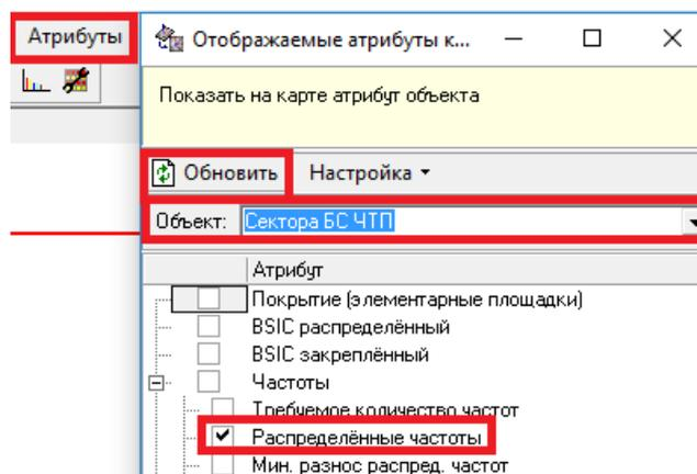
Рис. 5.20. Настройка отображения распределенных секторам БС частот
