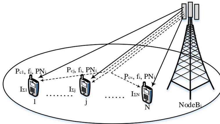
Рис.7.3. Разделение сигналов базовых станций в линии «вниз» сети UMTS
