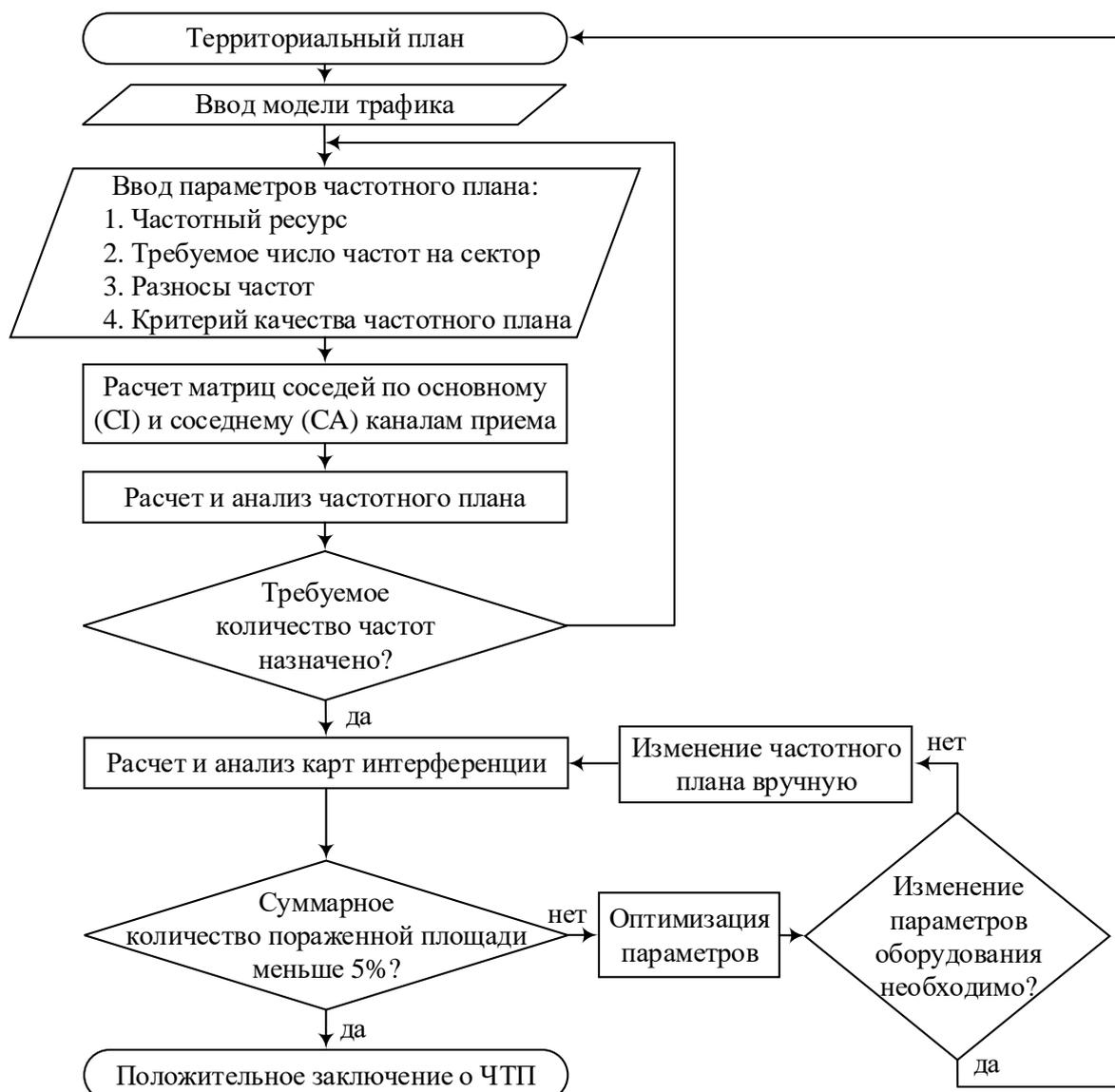
Рис. 5.4. Алгоритм частотного планирования в «ONEPLAN RPLS»
