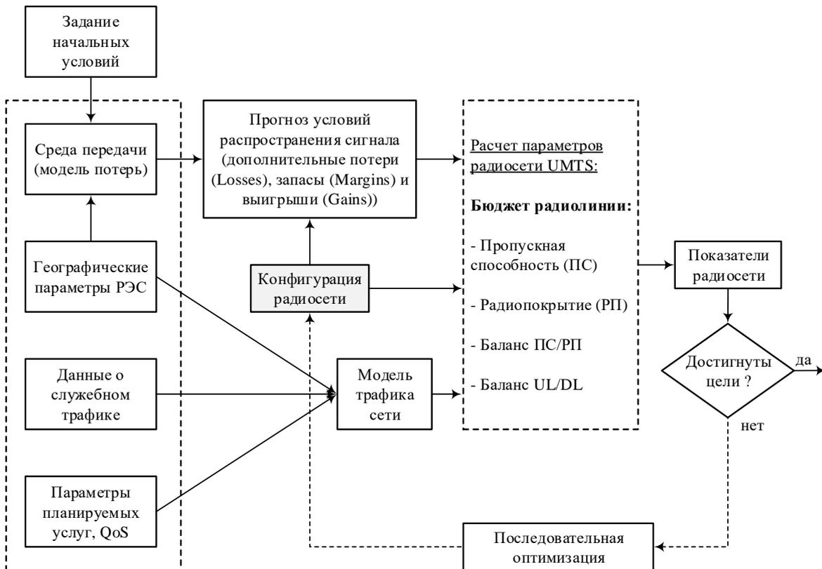
Рис.8.8. Общий алгоритм планирования и оптимизации радиосети UMTS
