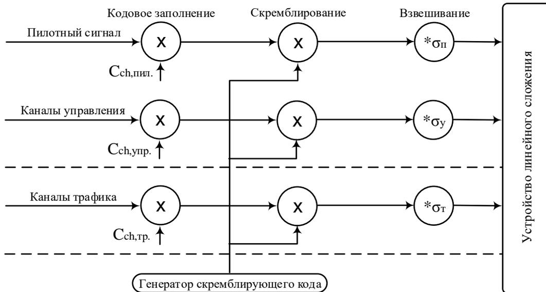
Рис.7.5. Мультиплексирование сигналов на БС UMTS
