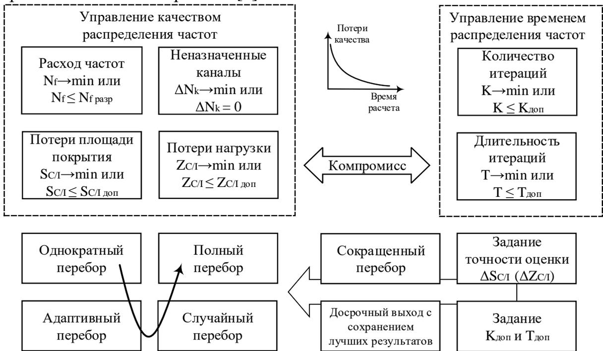
Рис. 5.6. Характеристики методики автоматического распределения частот
