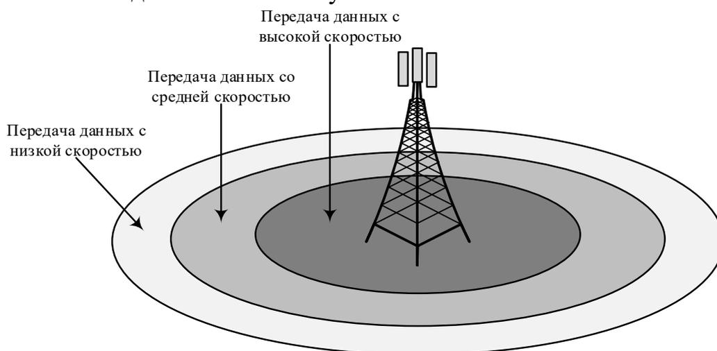
Рис.8.9. Скорость передачи и радиопокрытие в радиосети UMTS
