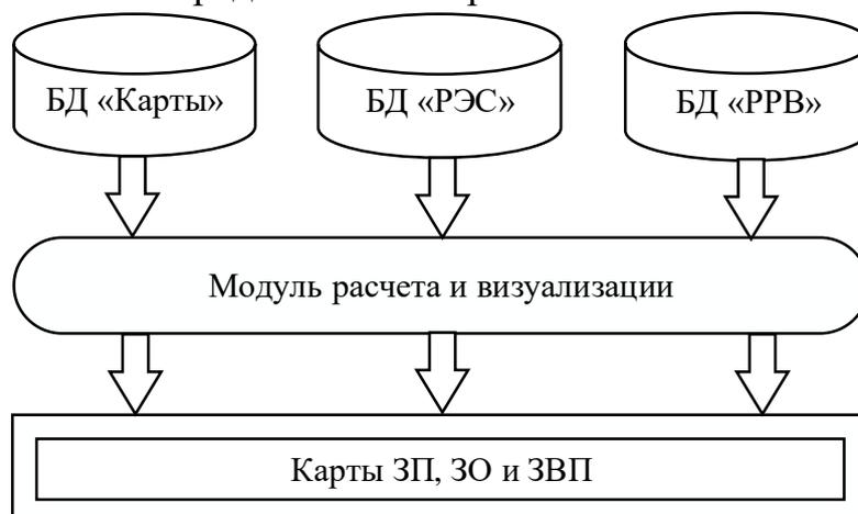
Рис. 2.1. Обобщенная схема САПР на основе ГИС для планирования радиосети СМС
