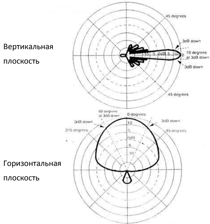
Рис. В.2. Диаграммы направленности реальной антенны в вертикальной и горизонтальной плоскостях
