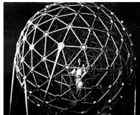
Рис.4 Размещение громкоговорителей на сфере в заглушенной камере
