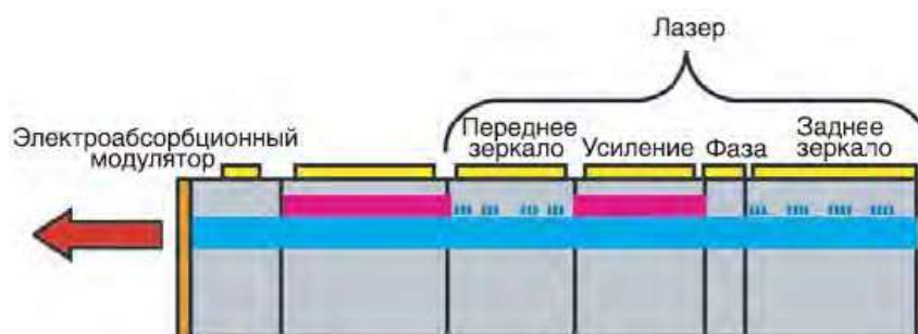
Рис. 2.15. Упрощенная конструкция и схема включения интегрированного моноблочного излучателя на основе ЛД SG DBR
