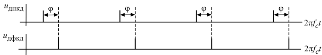
Рис.5. Временные диаграммы напряжений на входах ИФД
