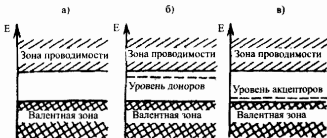
Рис. 10.1. Зонная структура полупроводников
