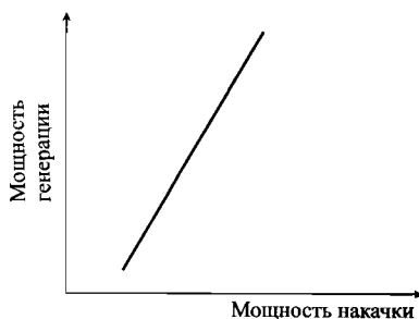
Рис. 6.18. Зависимость мощности генерации волоконного лазера от мощности накачки
