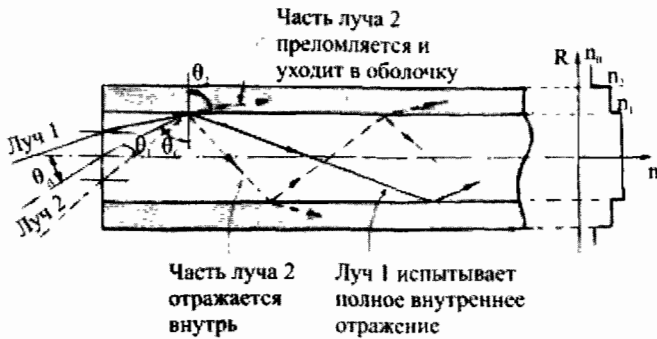
Рис. 6.10. Структура оптического волокна
