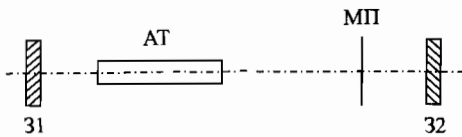
Рис. 11.23. Селекция продольных типов колебаний с помощью тонкой проводящей пленки
