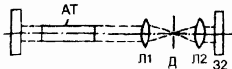
Рис. 11.12. Селекция поперечных типов колебаний с помощью диафрагмы
