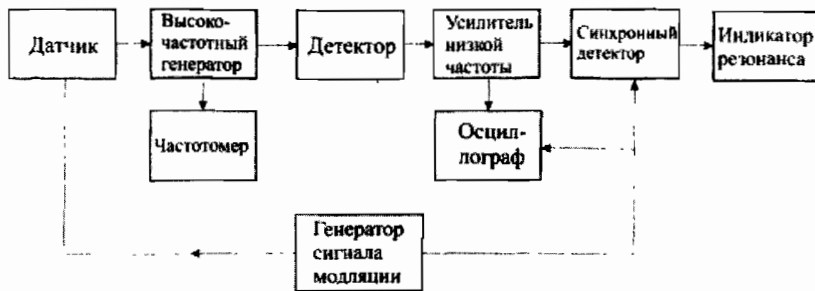
Рис. 14.2. Структурная схема ЯМР-магнитометра с неподвижным образцом
