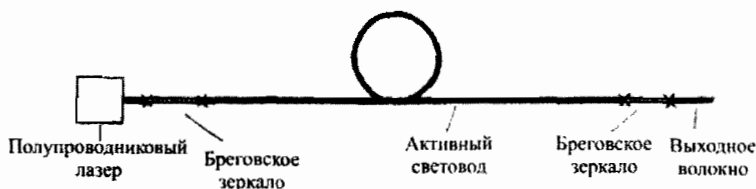
Рис. 6.16. Схема цельноволоконного лазера
