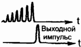
Рис. 11.10. Осциллограммы импульсов на выходном зеркале лазера
