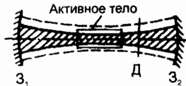
Рис. 11.11. Каустические поверхности в открытом резонаторе
