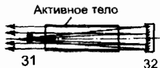
Рис. 11.16. Селекция поперечных типов колебаний с использованием неустойчивого резонатора
