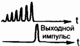
Рис. 11.10. Осциллограммы импульсов на выходном зеркале лазера
