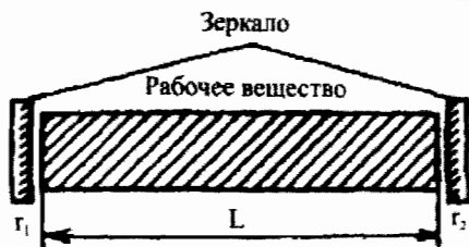
Рис. 4.5. Схема устройства лазера
