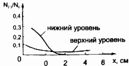
Рис. 7.21. Зависимость населенностей верхнего и нижнего лазерных уровней от расстояния до границы сверхзвукового сопла
