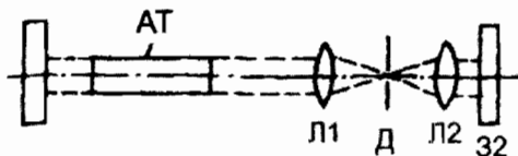
Рис. 11.12. Селекция поперечных типов колебаний с помощью диафрагмы
