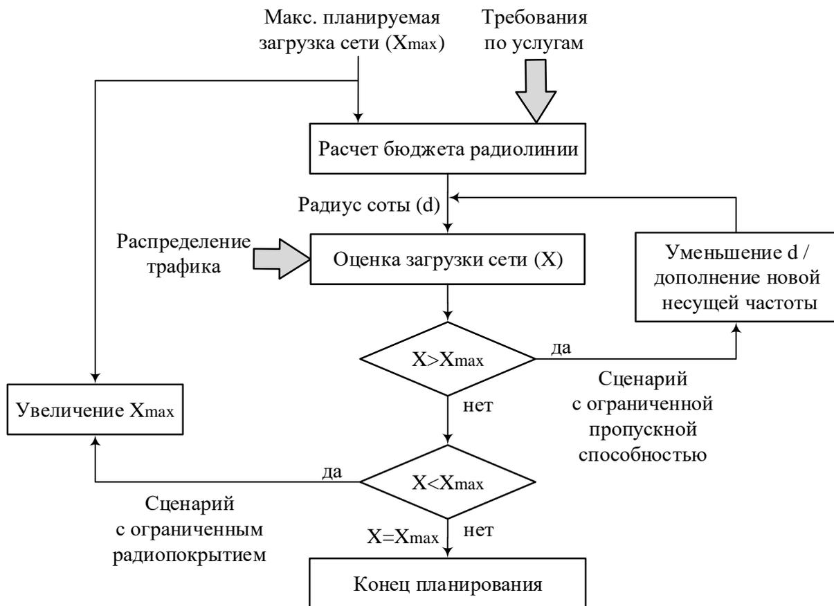
Рис.8.5. Балансировка пропускной способности и радиопокрытия
