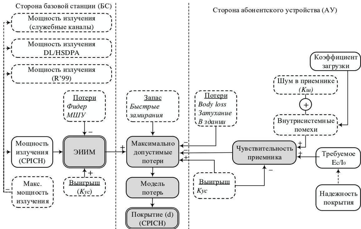
Рис.8.13. Алгоритм расчета зоны покрытия по каналу CPICH
