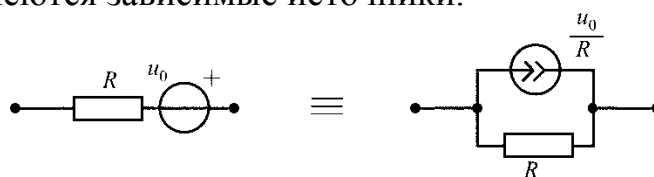
Рис. 2.7. Преобразование ветви с источником напряжения и резистивным сопротивлением в эквивалентную схему с источником тока
