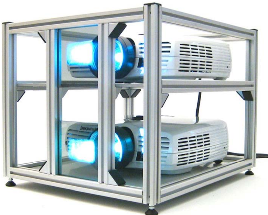
Рис. 4.4. Система из двух проекторов для демонстрации 3D-фильмов с использованием поляризационного метода разделения изображений
