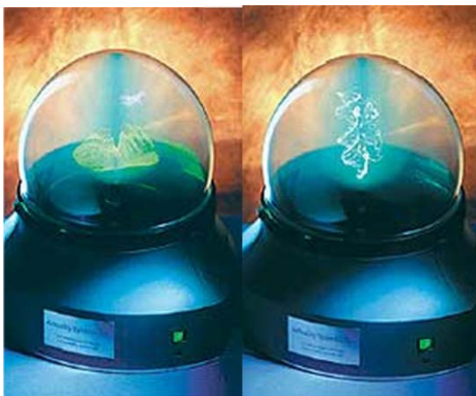
Рис. 4.10. Объемный дисплей фирмы Actuality, отображающий полет самолета над холмистой местностью (слева) и модель вируса (справа)
