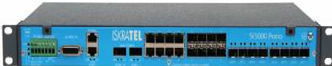
Рис. 4.2. Внешний вид коммутатора OLT в конструктиве 1U ( коммутатор GPON OLT SI3000 Поно производства компании ISKRATEL, Словения).
