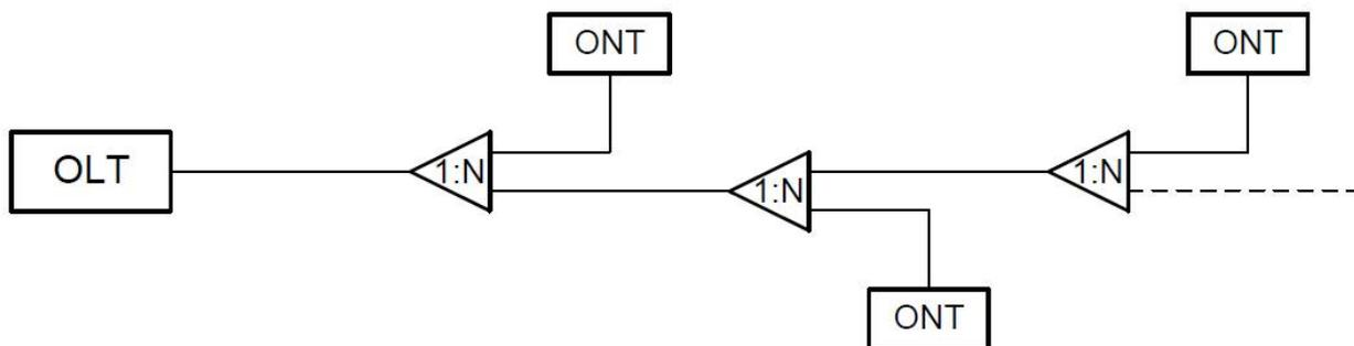
Рис. 1.6. Топология «шина» с использованием неравномерных разветвителей.
