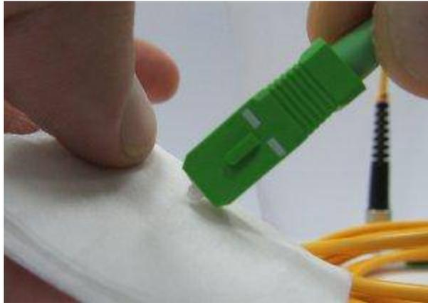
Рис. 3.1. Очистка торцов коннектора.
