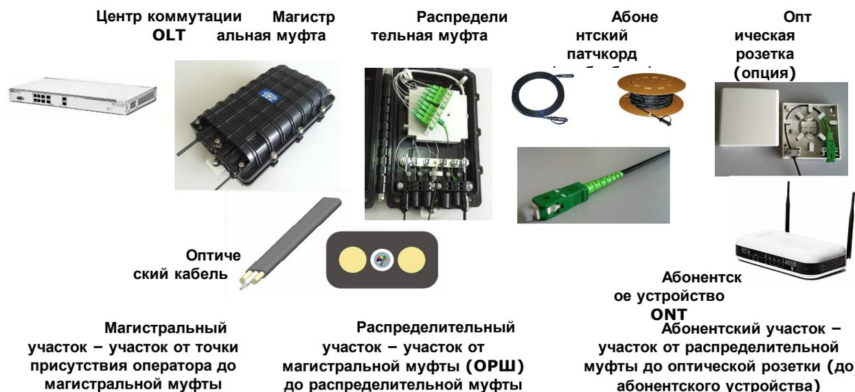
Рис. 2.2. Структура сети PON со всеми базовыми элементами.
