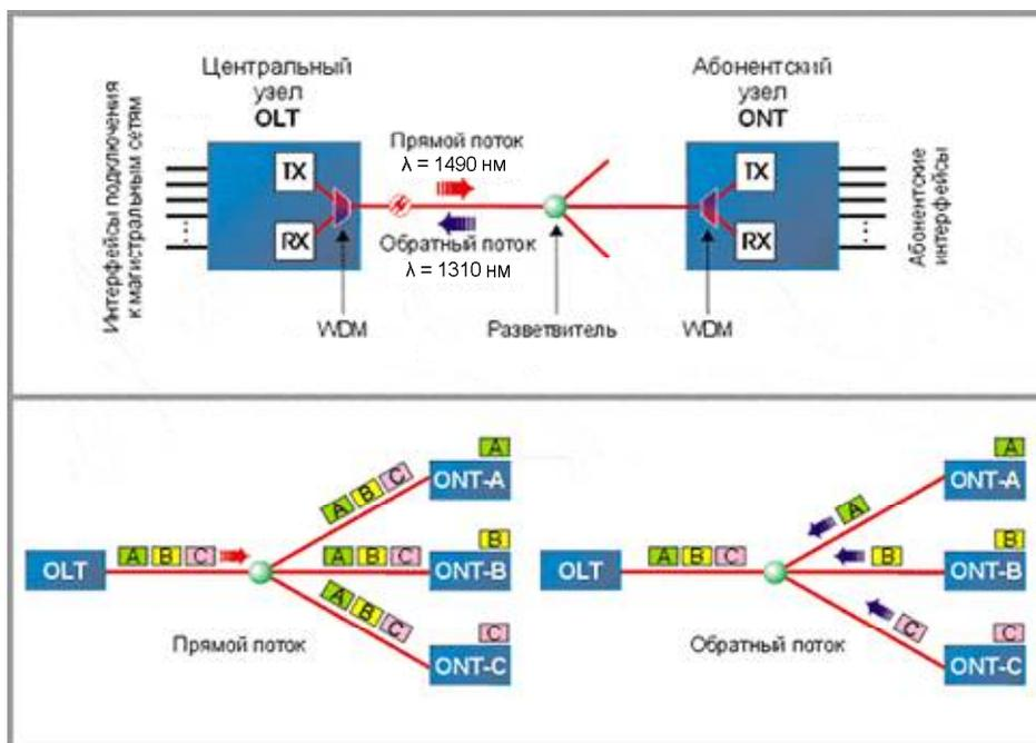
Рис. 1.2. Принцип действия и общий вид организации PON.
