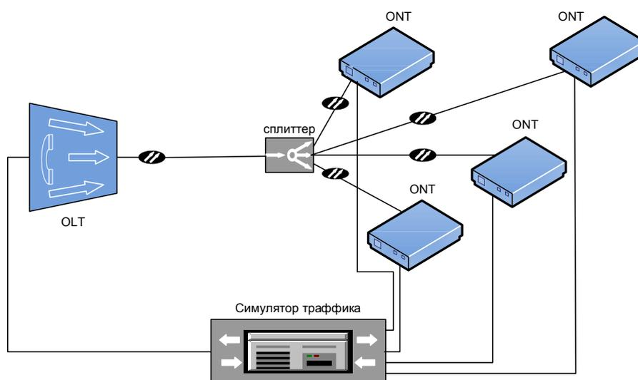
Рис. 4.4. Схема лабораторной установки для исследования организации VLAN.
