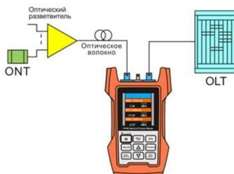
Рис. 2. Использование PON-тестера
