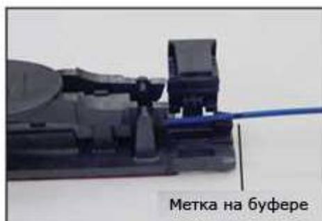
Рис. 2.12. Нанесение метки на буфере.
