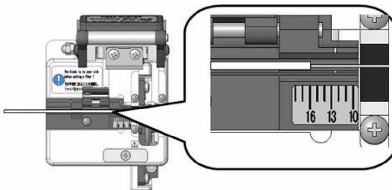
Рис. 2.7. Скалывание волокна на длине 16 мм.
