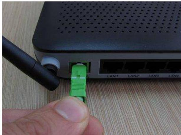
Рис. 3.2. Подключение патч-корда SC/APC.
