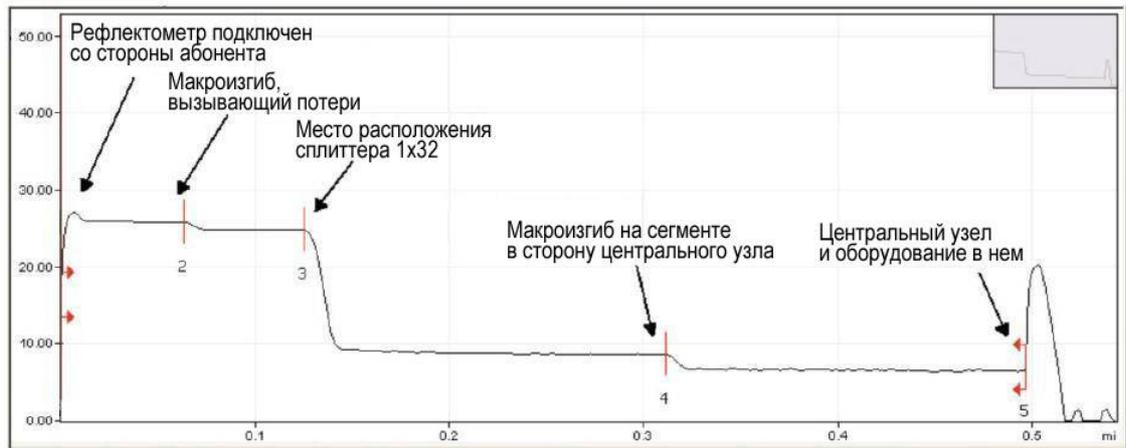
Рис. 5.4. Пример рефлектограммы, снятой со стороны абонента (ONT).
