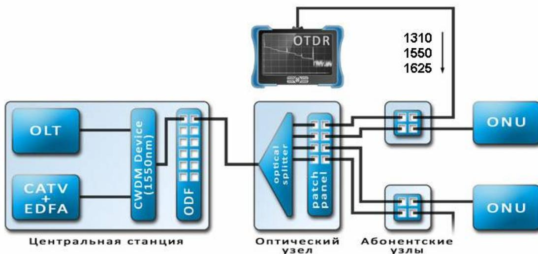
Рис. 5.3. Подключение рефлектометра (OTDR).
