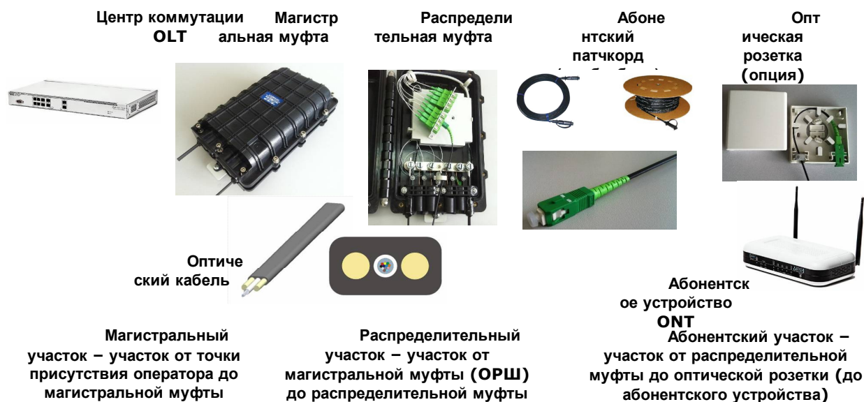
Рис. 5.13. Структура сети PON в малоэтажном жилом секторе.
