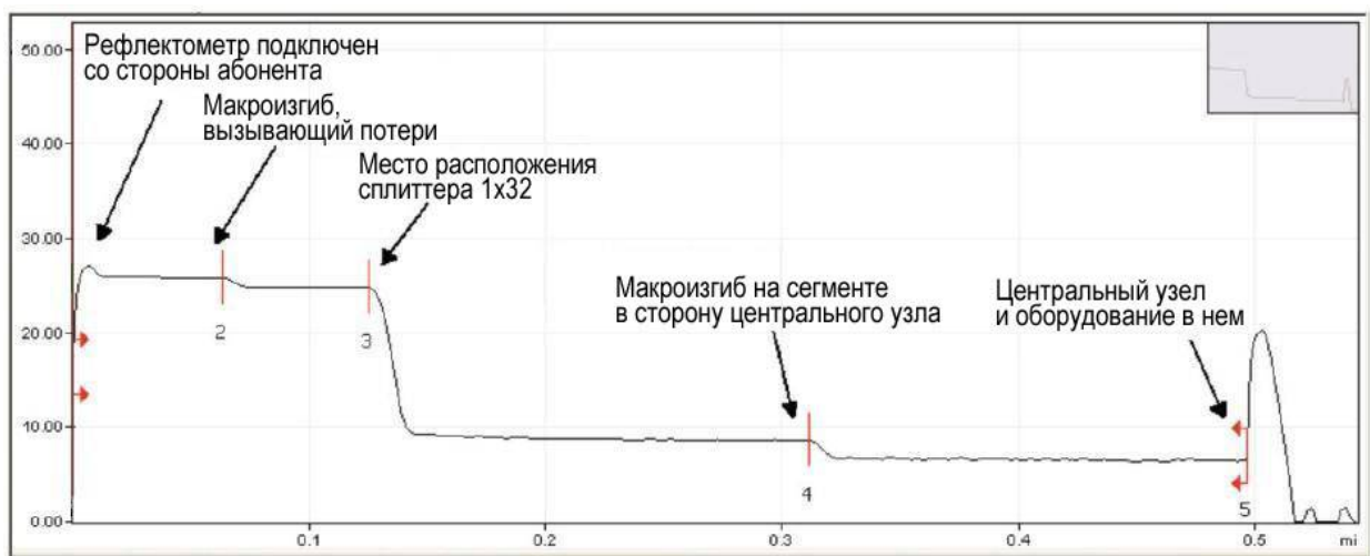
Рис. 7.9. Пример рефлектограммы, снятой со стороны абонента (ONT/ONU).
