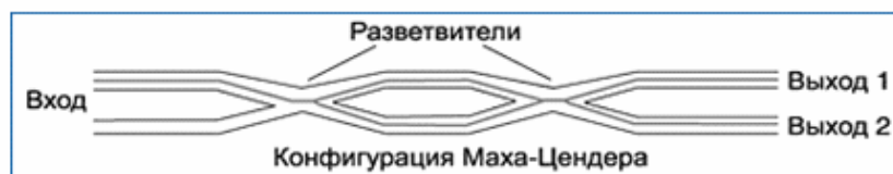
Рис. 5.8. Распределение входного сигнала между 2 выходами
