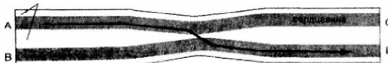
Рис. 5.6. Оптический разветвитель на основе одномодового волокна
