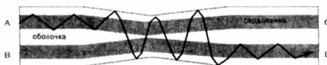
Рис. 5.5 Разветвитель на основе многомодового волокна
