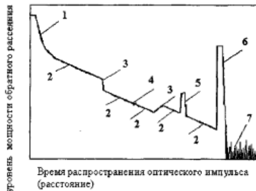
Рис. 1.1. Характеристика обратного рассеяния участка оптической линии
