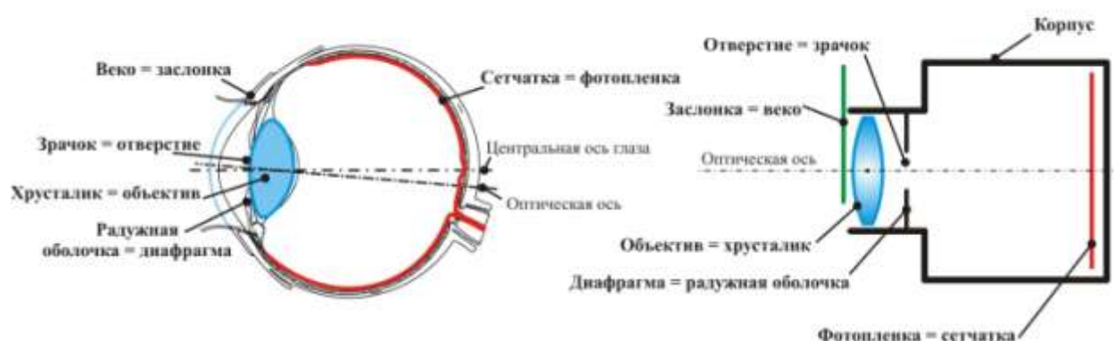
Рисунок 3.25. Схема сравнения фотоаппарата и человеческого глаза
