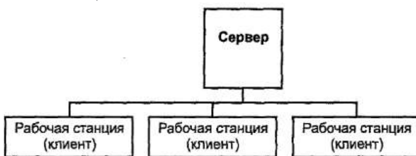
Рис. 1.2 - Типовая сетевая архитектура «клиент-сервер»
