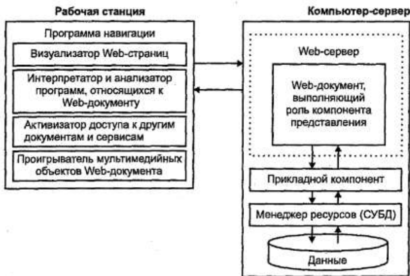
Рис.1.7 - Архитектура «клиент-сервер», основанная на Web-технологии
