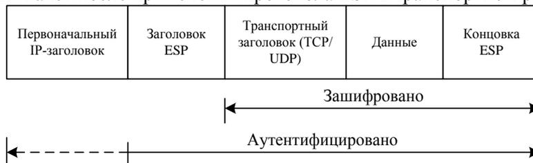
Рис. 18. Работа протокола ESP в транспортном режиме без АН.
