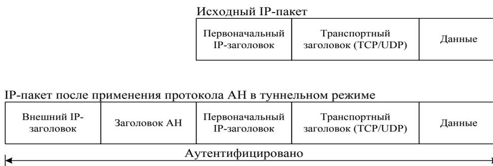
Рис. 17. Работа протокола АН в туннельном режиме.
