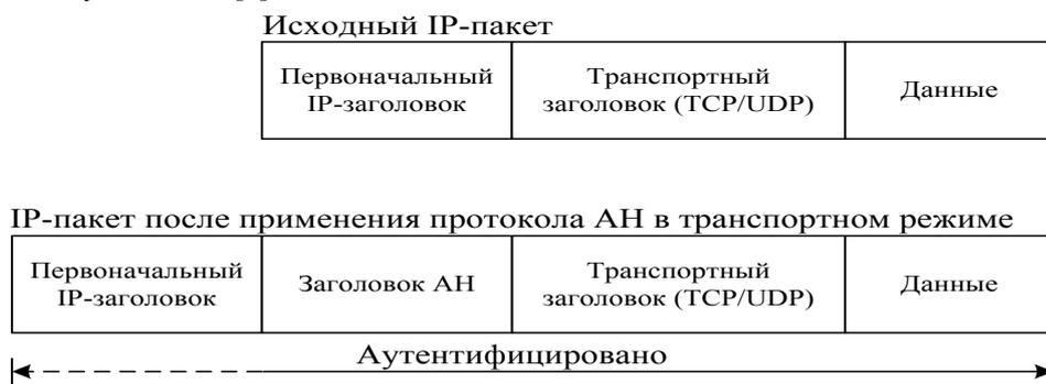
Рис. 16. Работа протокола АН в транспортном режиме.
