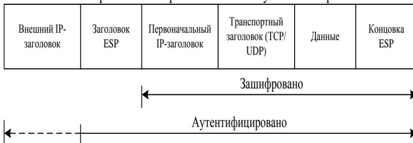
Рис. 21. Работа протокола ESP в туннельном режиме без АН.
