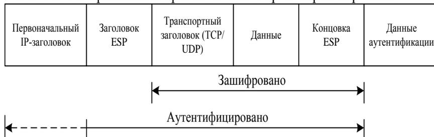
Рис. 20. Работа протокола ESP в транспортном режиме с АН.
