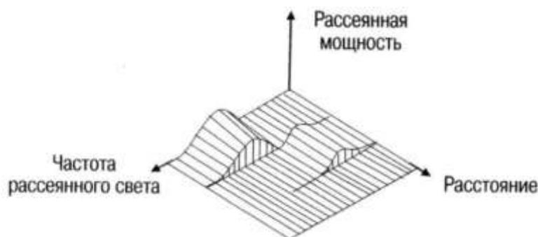
Рис 2.15. Распределение спектра бриллюэновского рассеяния света в волокне
