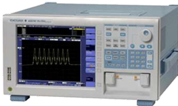
Рис.1.7. Внешний вид оптического анализатора спектра Yokogawa AQ 6370
