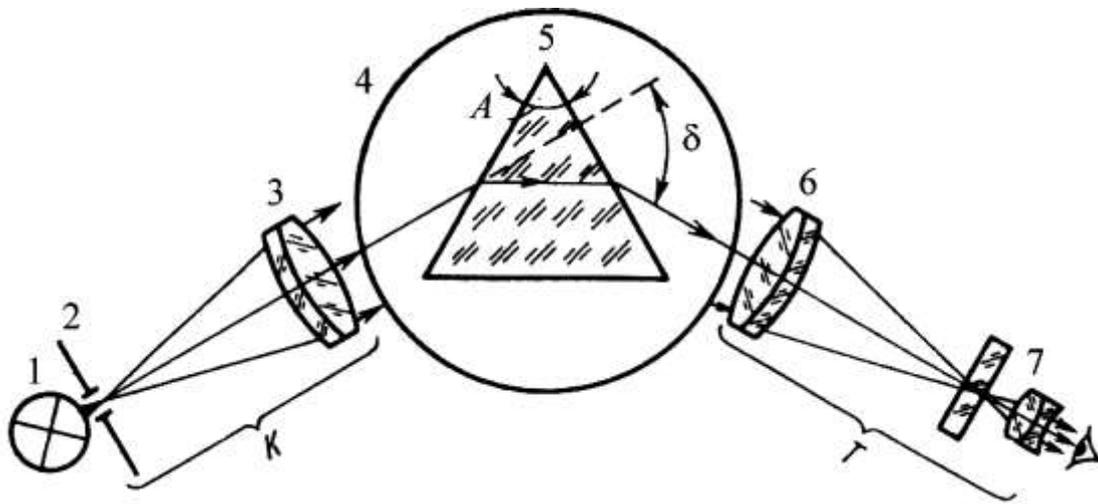
2. Схема измерения показателя преломления на гониометре методом наименьшего отклонения: К – коллиматор, Т – зрительная труба, 1 – источник света, 2 – входная щель, 3 – объектив коллиматора, 4 – стол гониометра, 5 – призма, 6 – объектив зрительной трубы, 7 – окуляр зрительной трубы
