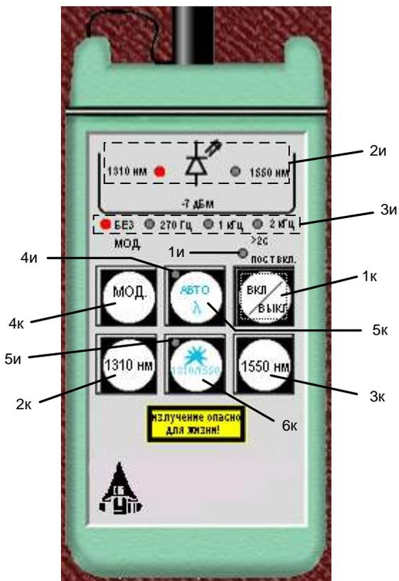
Рис. 1. Внешний вид и органы управления источника излучения
