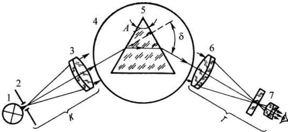
Рис. 2. Схема измерения показателя преломления на гониометре методом наименьшего отклонения:  $K$  – коллиматор,  $\Gamma$  – зрительная труба, 1 – источник света, 2 – входная щель, 3 – объектив коллиматора, 4 – стол гониометра, 5 – призма, 6 – объектив зрительной трубы, 7 – окуляр зрительной трубы
