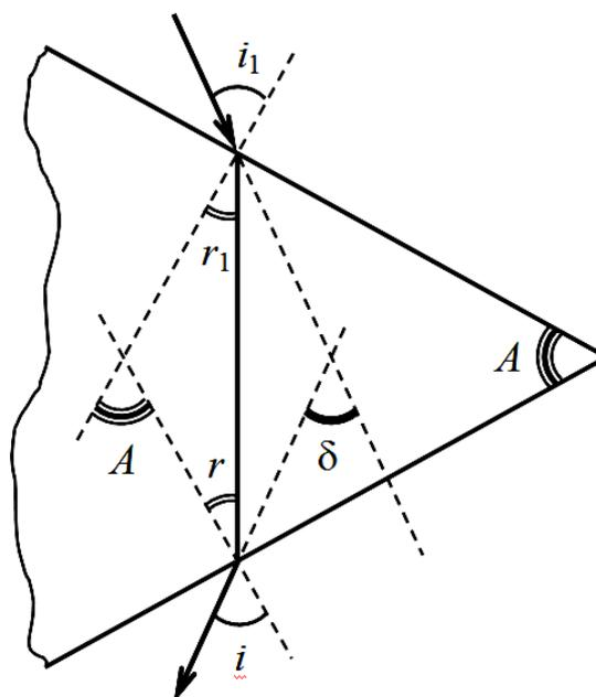
Рис. 1. Ход лучей в призме. Угол  $A$  – преломляющий угол призмы, угол  $\delta$  обозначает отклонение луча призмой
