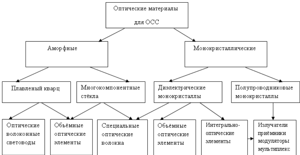
Рис.2. Материалы компонентов оптических систем связи
