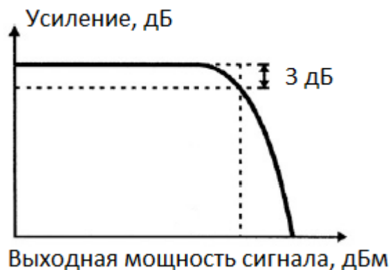
Рис. 3. Зависимость усиления сигнала от его выходной мощности.
