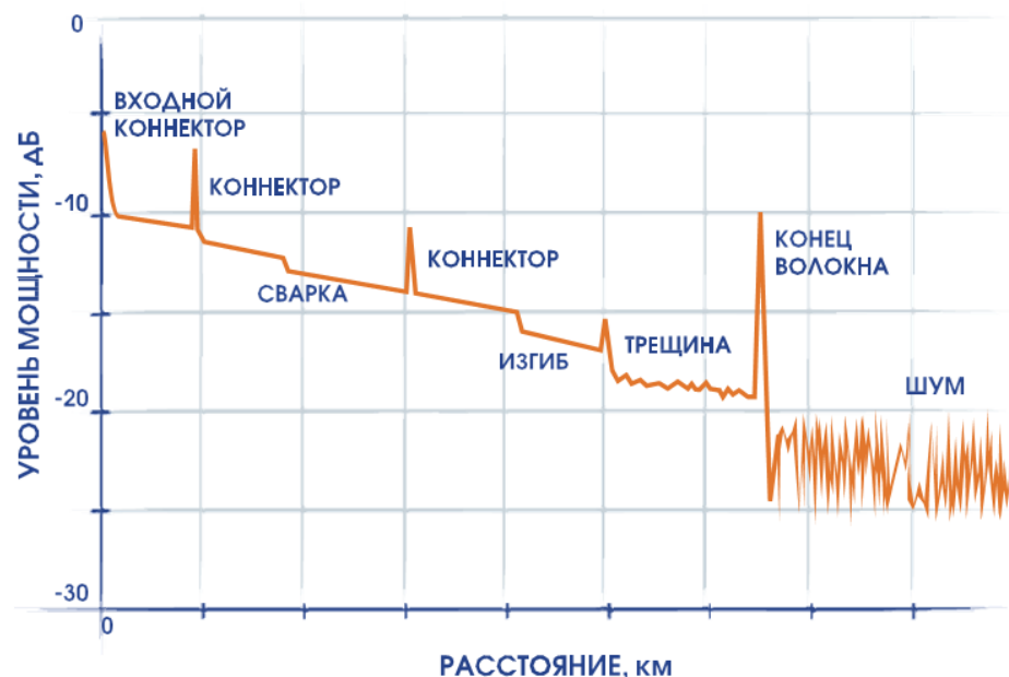
Рис.8.4. Типичная рефлектограмма импульсного рефлектометра
