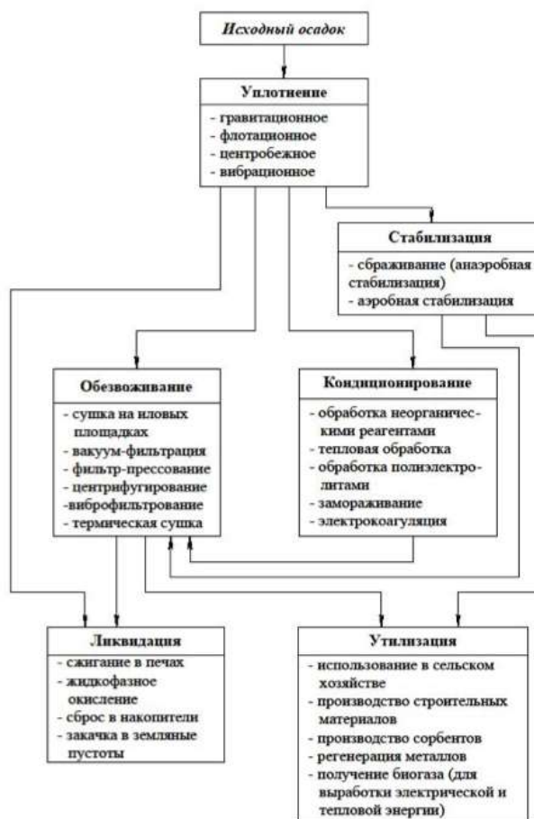
Рис. 1. Технологические процессы обработки осадков сточных вод
