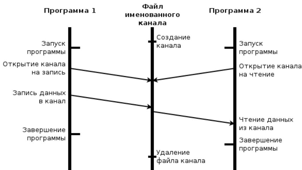
Рис. 3. Диаграмма последовательности работы программ при взаимодействии через именованный канал
