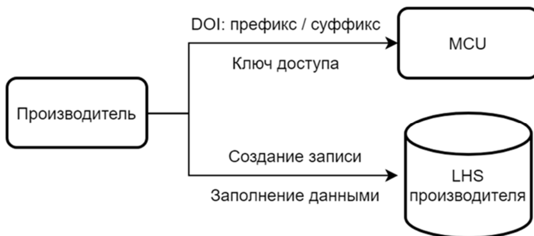
Рисунок 5 – Внесение базовой информации в устройство на микроконтроллере на этапе производства
