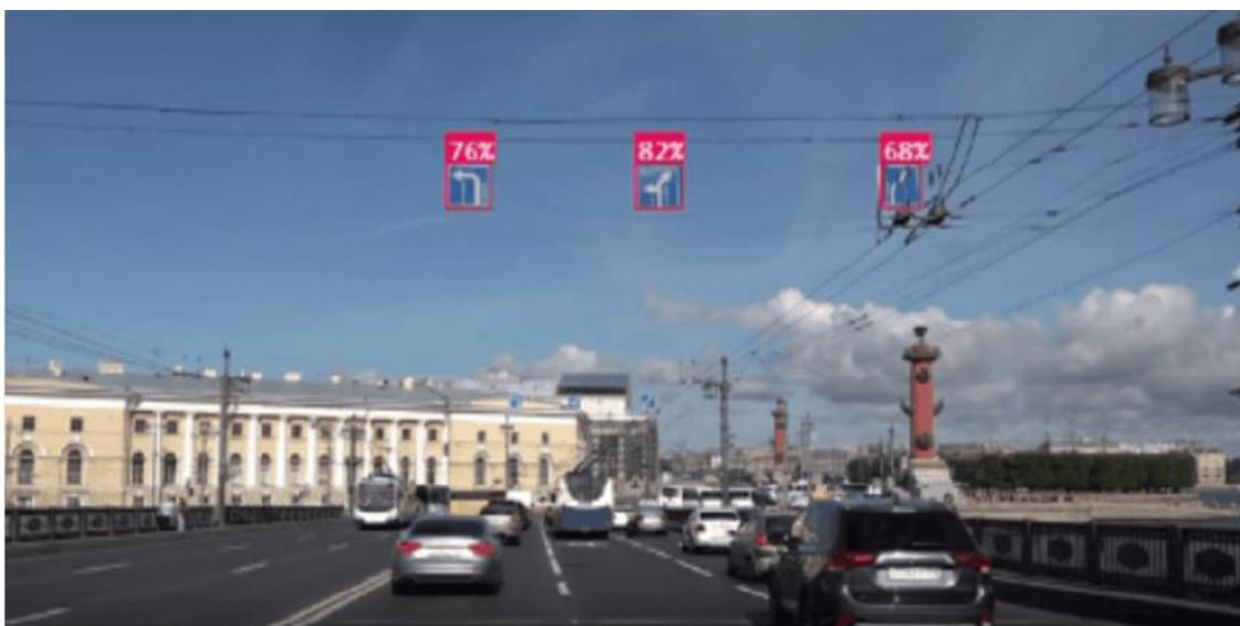
Рис. 3. Пример работы сервиса определения дорожных знаков
