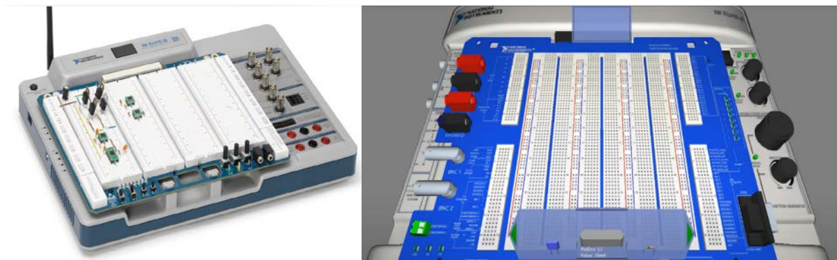
Рисунок 1.6 – Настольная станция прототипирования NI ELVIS III с установленной макетной платой [73].
