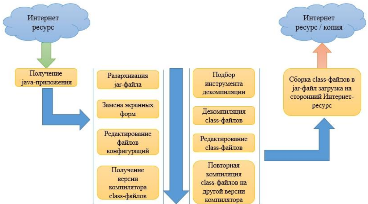
Рисунок 3.1 – Возможная модель действий нарушителя
