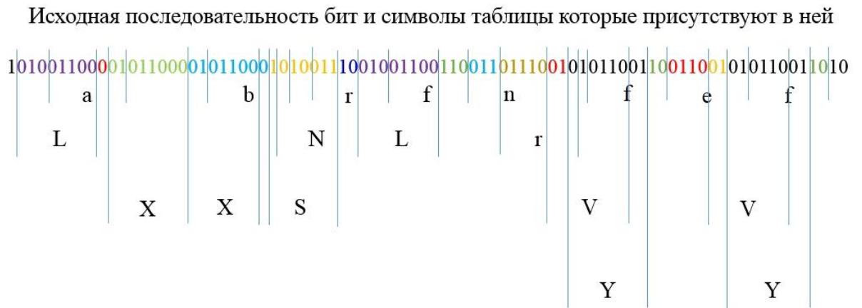
Рисунок 2.7 – Возможные символы в битовой последовательности опкодов оригинального class-файла
