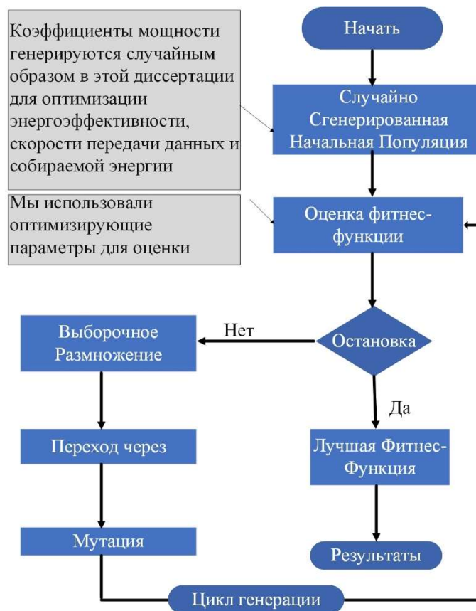
Рисунок 1.4 – Иллюстрация блок-схемы генетического алгоритма [21].
