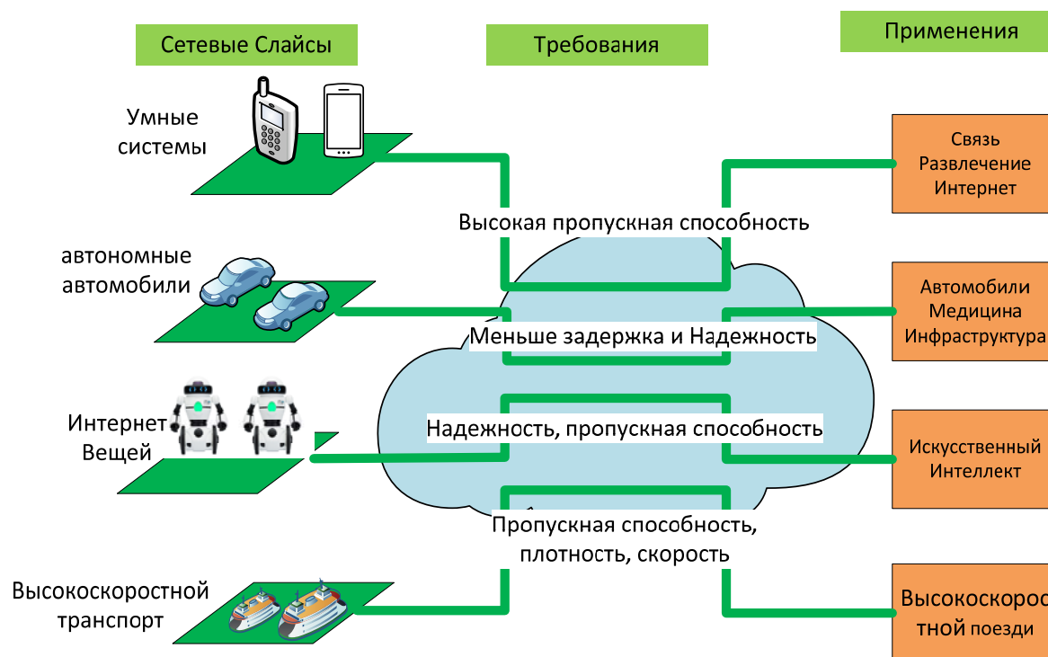
Рис. 2. Сетевые виртуальные функции в мобильных сетях связи 5G/IMT-2020 и соответствующие ими требования для сетевых слайсов
