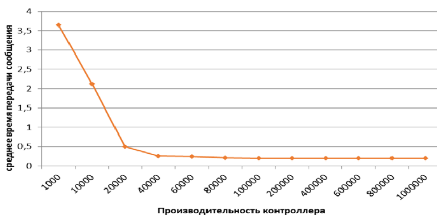
Рис. 8. График зависимости времени обработки сообщения от производительности контроллера
